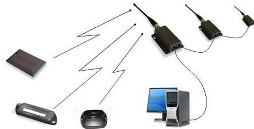
Figura 3. Marcadores, antenas y sistema de gestión.
