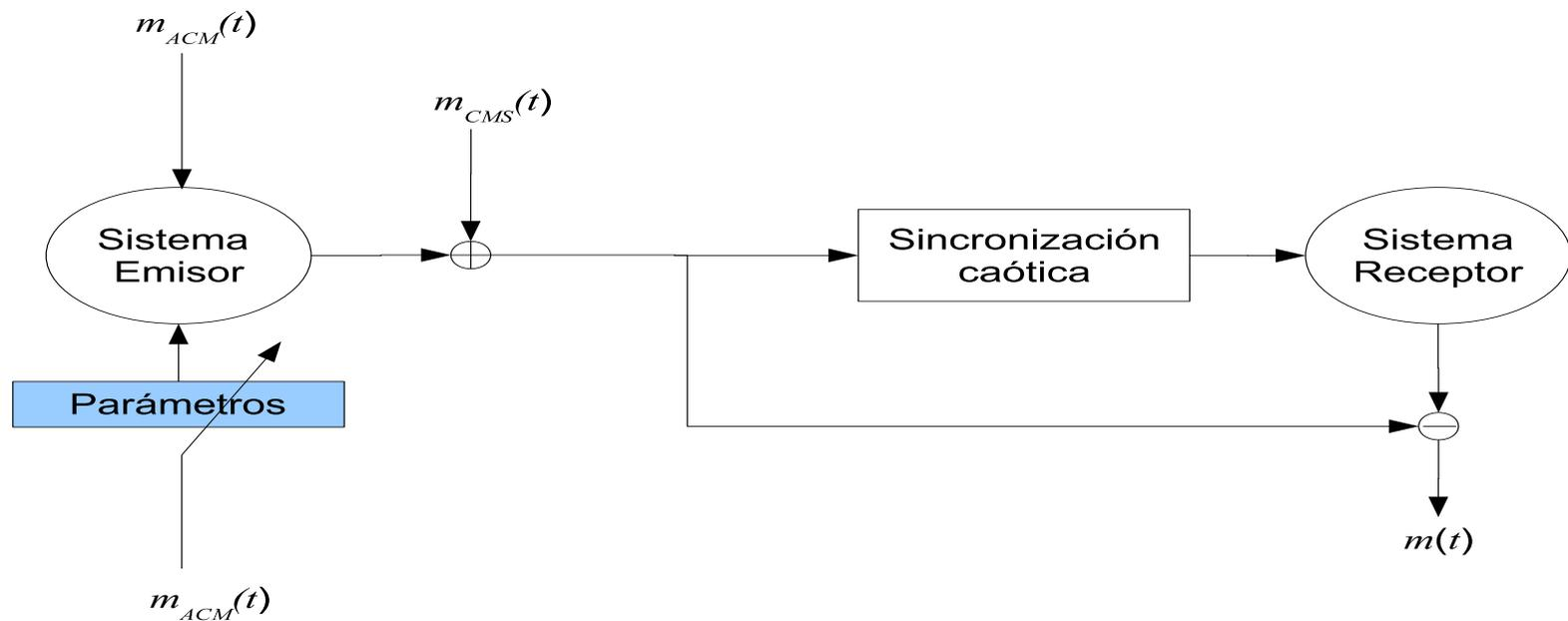
Esquema básico de un sistema de comunicación basado en la sincronización. ACM: Additive chaos modulation. CMS: Chaos masking.
