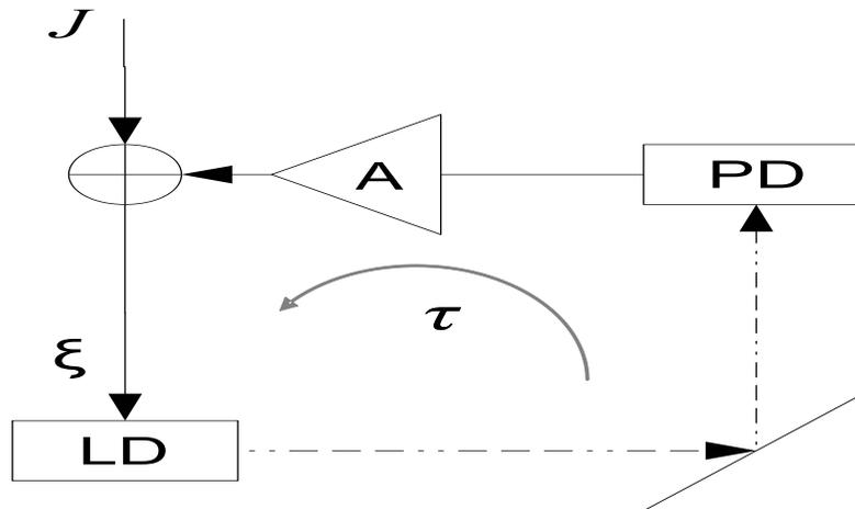
Esquema de un sistema de láser semiconductor con feedback optoelectrónico retardado. La línea discontinua indica el camino óptico.
