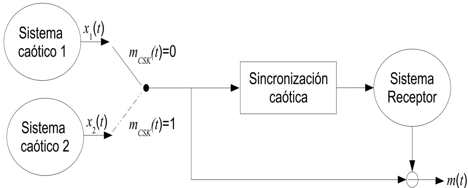
Esquema básico de un sistema de comunicación basado en la sincronización. CSK: Chaos shift keying.
