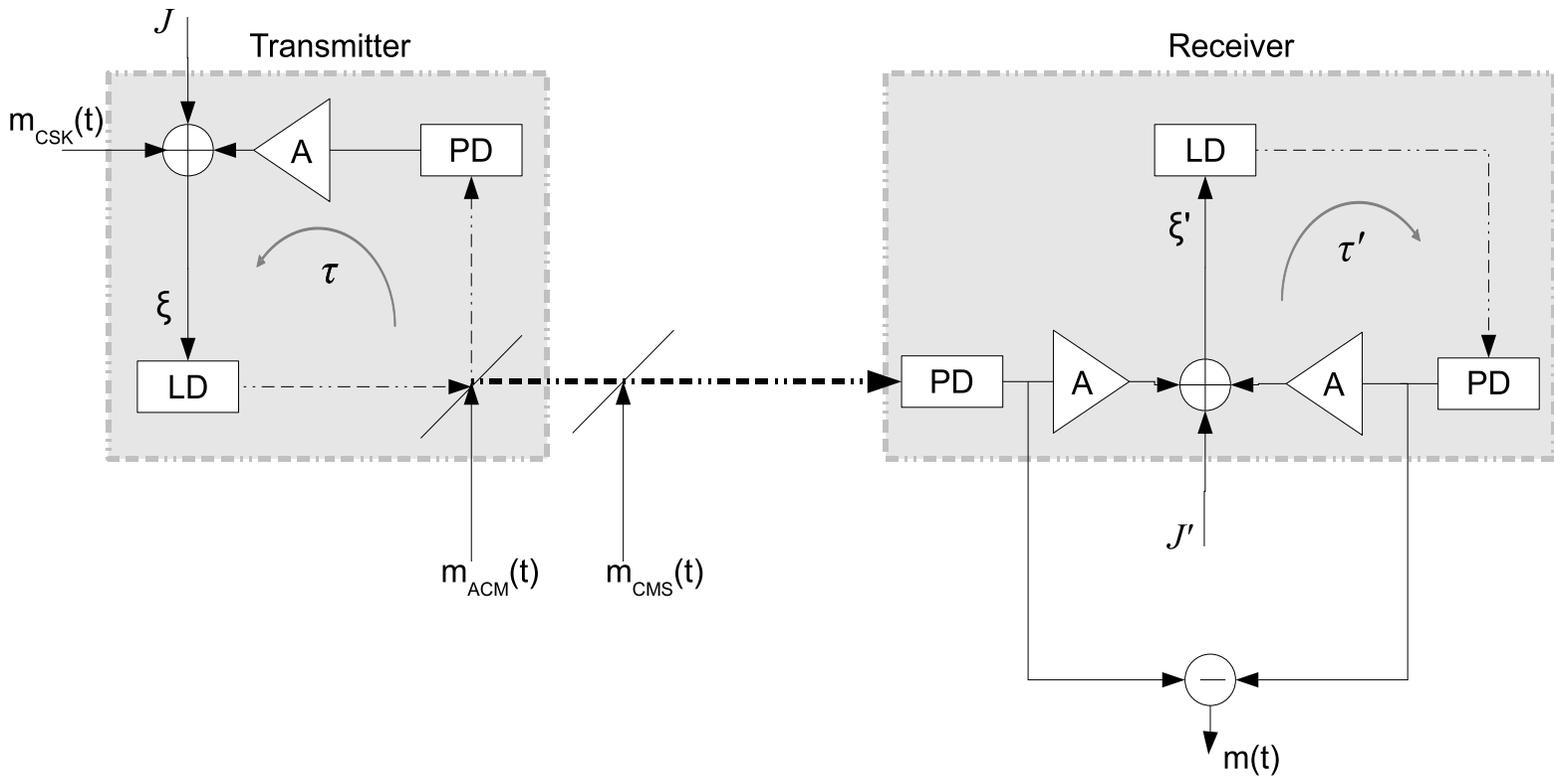
Esquema unidireccional de comunicación usando láseres de semiconductor con feedback optoelectrónico retardado.
